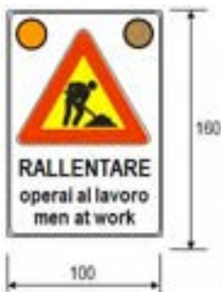
Figura 18: pannello composto di presegnalazione per lavori eseguiti lungo le corsie di decelerazione o sulle rampe di svincolo, dotato di 2 lampade a led ad alta efficienza diam. 200 mm. Superficie della targa non inferiore a 1,5 mq con lato del triangolo lavori in corso non inferiore a 90 cm. Posizionamento sul margine destro in coincidenza dell’ago di inizio della decelerazione e ripetuto in condizioni di non perfetta visibilità.
