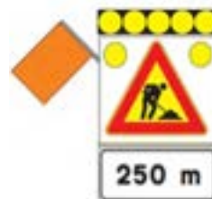
Figura 14: "segnale mobile di preavviso" derivato dalla fig. Il 400 Art.39 Reg. da impiegare per lavori sulla sola corsia di emergenza. E' integrato con set di 6 lampade a led ad alta efficienza luminosa diam. 300 mm (con possibilità di lampeggio sincrono e sequenziale) e con sbandieratore elettromeccanico posto in alto sul lato esposto al traffico.
