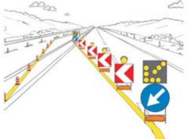
TESTATA DI DEVIAZIONE PER CANTIERE > 7 GIORNI
