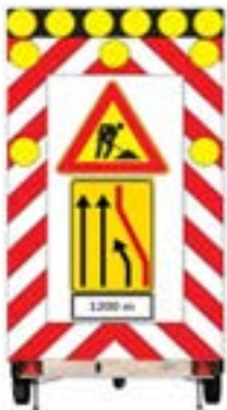
Figura 6: fig. II 400 per la chiusura di una o più corsie di transito (la figura esemplifica la chiusura della corsia di marcia in dx). E' integrato con set di 6 lampade a led ad alta efficienza luminosa diam. 300 mm (con possibilità di lampeggio sincrono e sequenziale).
