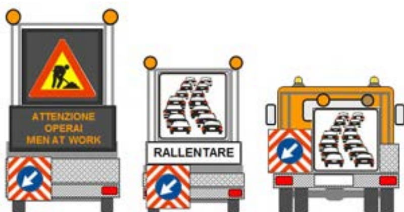
Figura 3: esempi di presegnalazione integrativa su veicolo o carrello. I pannelli "code" o "lavori in corso" devono avere dimensioni non inferiori a 120x120 cm. Il cartello Fig. II 388 Art.38 Reg. (90x90), va sempre previsto.
