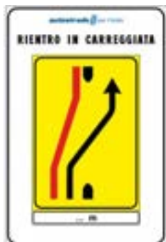
Pannello composto di informazione, modificabile con lamierini da installarsi nella corsia in deviata. Dimensioni 135*200 cm, su cavalletto.
