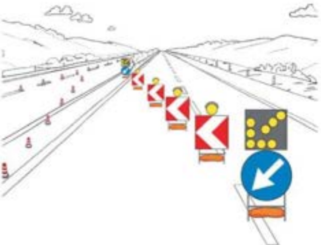
TESTATA DI DEVIAZIONE PER CANTIERE \leq 2 GIORNI
