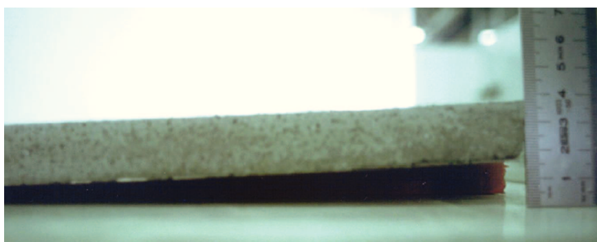
Figura 15-6 - Misura della concavità ai lembi estremi del provino di una malta che ritira all'aria
